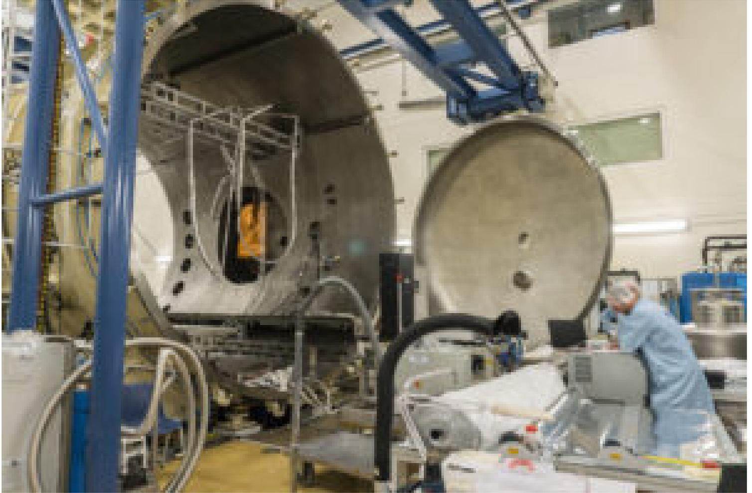
Dans l'imposante cuve de 5 mètres de diamètre FOCAL 5, le CSL simule l'environnement spatial auquel est soumis l'instrument à tester © Laetitia Theunis
