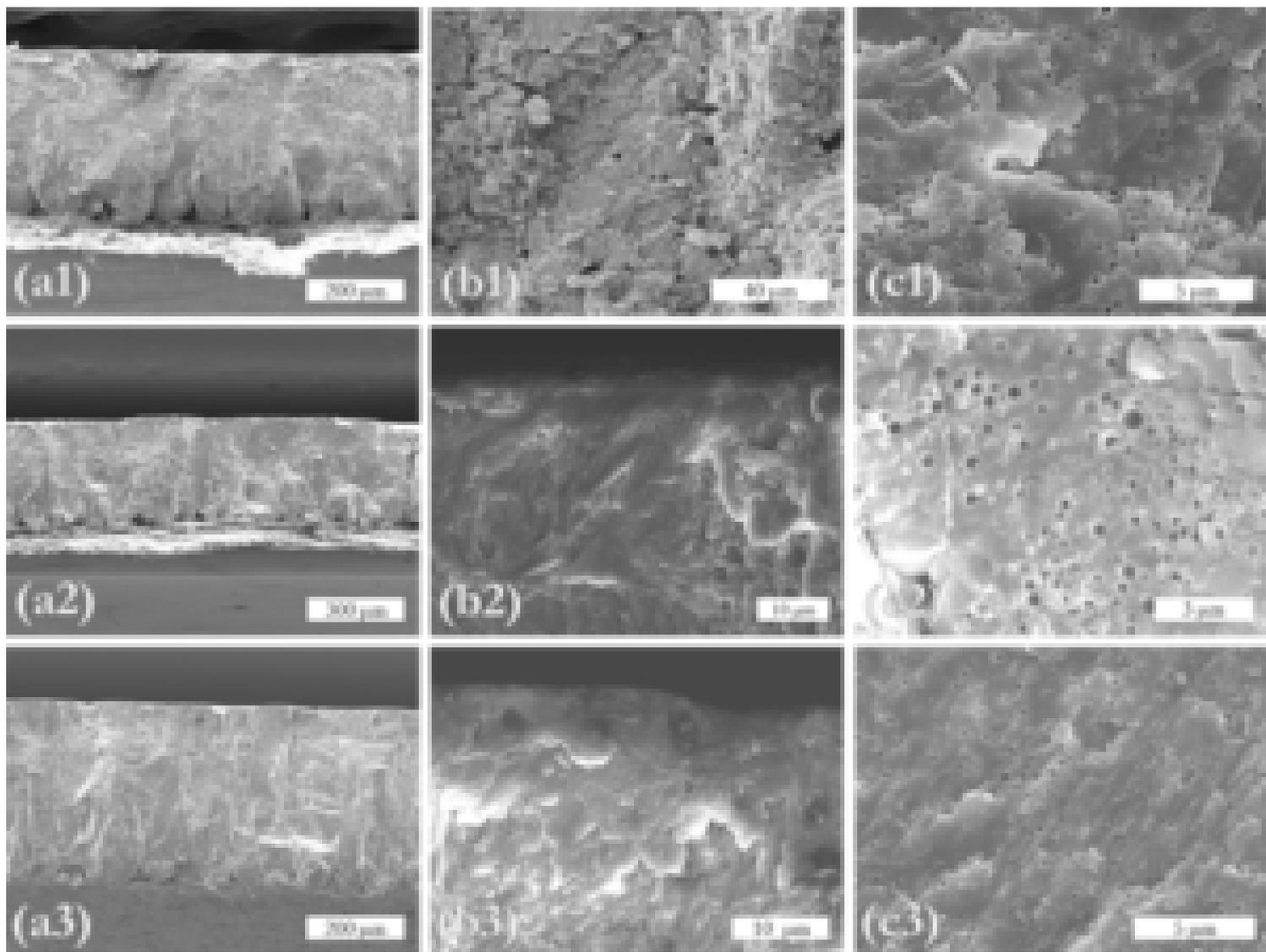
Image de microscopie électronique de la structure de la coquille de 3 races de volaille révélant la présence de petits pores sphériques © Mathieu Ladouce / LPS UNamur
