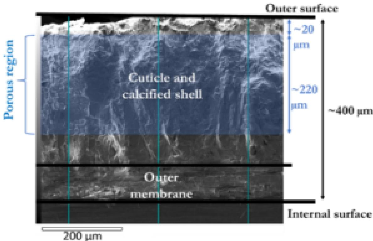
Les micro-orifices sont percés dans la coquille à des profondeurs allant de 20  $\mu\text{m}$  à 240  $\mu\text{m}$  à partir de sa surface externe © Mathieu Ladouce / LPS UNamur
