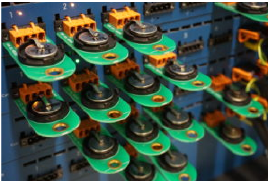
Prototypes de batteries organiques en test au laboratoire du Pr Vlad (c) Laetitia Theunis
