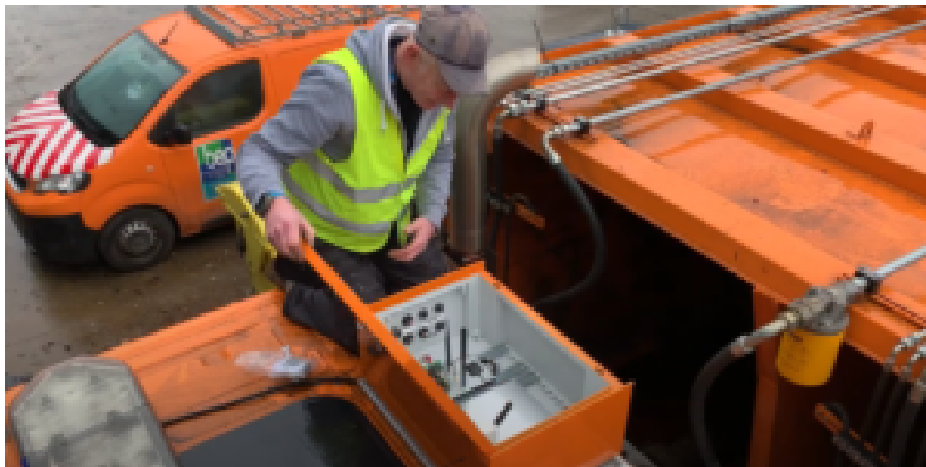
Capteurs installés sur les camions poubelles © BEP Namur
